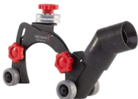
AirChaser 125 Past op 125mm haakse slijper. Diepte instellen tot ca. 35mm. Geschikt voor het frezen van sleuven d.m.v. meegeleverde verloopmoeren 5020002
